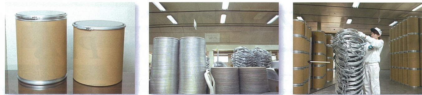
写真左の左が従来のファイバードラムで、右が「Aドラム」。金具を取り外すのが容易になった。ファイバードラムを補強する金具(中)。ファイバードラムの組み立てにおいては社員による手作業が重要である(右)
